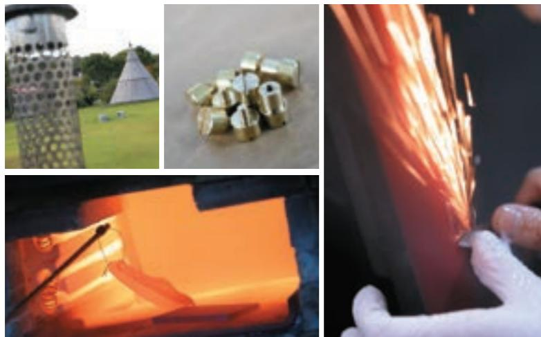
板状の刃を粗研磨。刃がアール形状なので熟練の技術が要る作業です。実はこの研磨用の工作機械も全部現場の職人による手作り。粗い刃付けから細かい刃付け、バフ掛けも行います(上段右&下段左写真)。青力ミ2号は900度に設定された炉の中でじっくりと焼きます(ステンレス鋼は1000度に設定)。ここで刃こぼれする刃になるかどうかが決まる重要な焼き入れ作業。温度管理が重要なため炉の中には温度計を複数本用意(中段左)。
